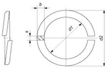
**Шайбы DIN 127, пружинные (гровер)** — применяются в строительстве, машиностроении в качестве контрящих элементов соединения.
