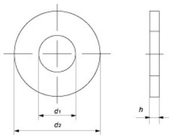
**Шайбы DIN 9021 / ГОСТ 6958-78, плоская усиленная (кузовная)** — особенность: внутренний диаметр шайбы плоской усиленной приблизительно в 3 раза меньше внешнего диаметра шайбы.
