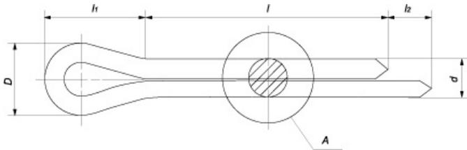
**Шплинт ГОСТ 397-79** — металлическое крепление, изготавливаемое в виде проволочного стержня полукруглого сечения, согнутого пополам с образованием ушка в месте сгиба. Применяется в качестве фиксирующего элемента слабо нагруженных сопряжённых деталей и для предотвращения самоотвинчивания гаек.
