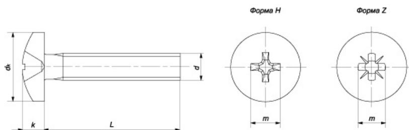
**Винт DIN 7985, класс прочности 5.8** — оцинкованный винт с цилиндрической головкой с крестообразным шлицем и закругленным торцом применяется в машиностроении, приборостроении, автомобилестроении, мебельной промышленности для соединения деталей машин и механизмов.
